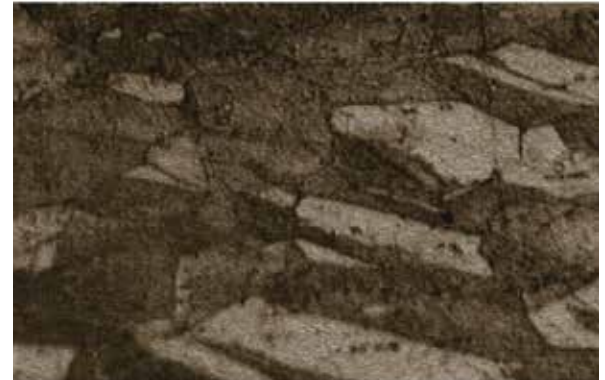
Estructura convencional de grano CuCrZr
