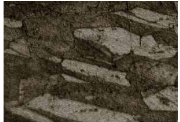
Korngefüge konventioneller Cu-Cr-Zr-Legierungen
