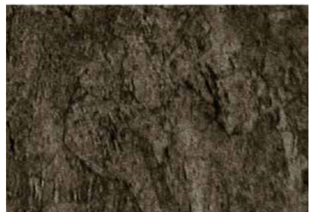
Luvata-Feinkorngefüge von Cu-Cr-Zr
