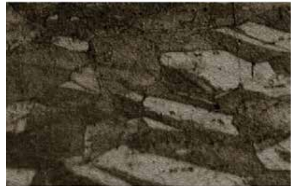
Struttura del grano tradizionale della lega CuCrZr
