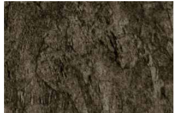
Struttura a grano fine della lega CuCrZr Luvata
