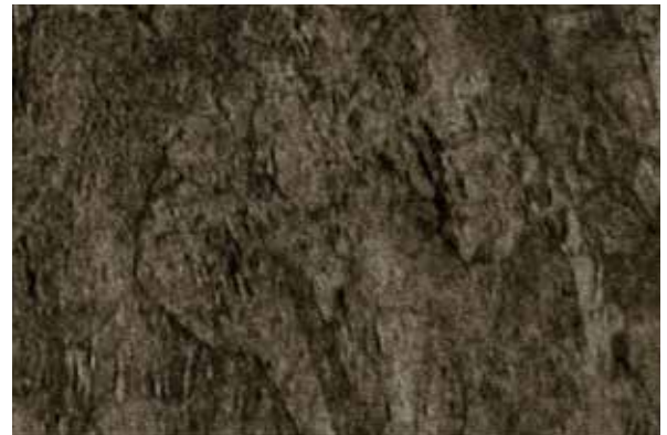
Luvata 製品のCuCrZr 微粒子構造
