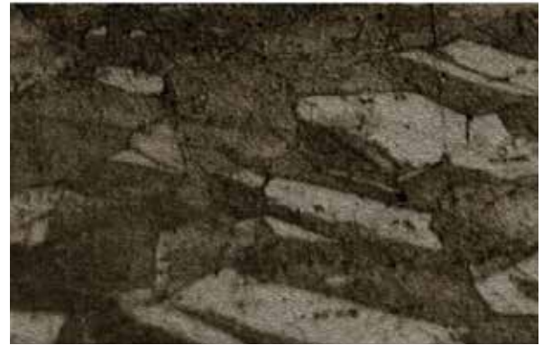
Estrutura convencional de grãos CuCrZr
