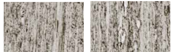
弥散铝强化铜在 900°C 高温退火前后的金相对比图
