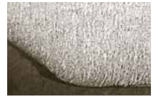
弥散铝强化铜在焊了 1200 个点后的金相图
