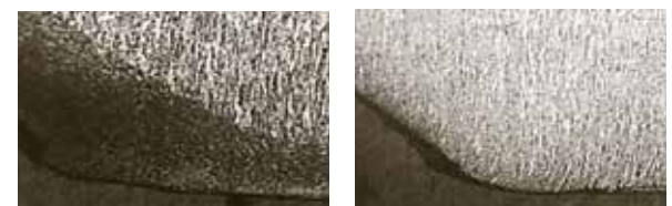
CuCrZr après 1200 soudures
