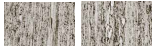
Nitrode-Elektrode vor und nach dem Glühen bei 900 °C
