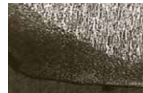
CuCrZr dopo 1200 saldature
