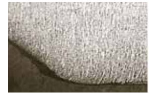
Nitrode dopo 1200 saldature
