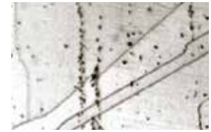
CuCrZr prima e dopo la ricottura a 900°C
