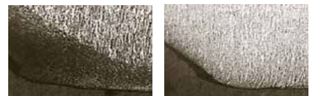
CuCrZr após 1200 pontos de solda
