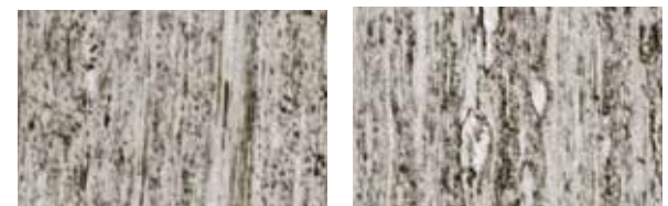
Nitrode antes e depois do recozimento a 900°C
